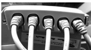
Installare la camma di bloccaggio sui connettori della centralina.
