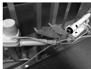
Collegare il cavo del motore hi/lo dalla pediera e il cavo dal motore della sezione cosce/gambe fino al perno tubolare del motore della sezione cosce/gambe. Assicurarsi che il perno tubolare sia bloccato correttamente.
